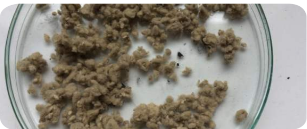
Figure 4 : Débris de calorifuge type PROTECT 1000S obtenus après vieillissement thermique, et destruction au « laser-jet », puis séchage simple – Fibres de longueur moyenne 500µ
