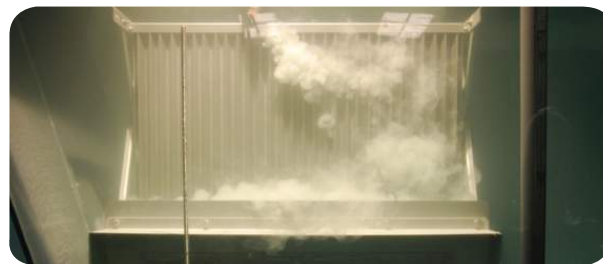
Figure 1 : Test de mesure de perte de charge de compartiments filtrants en situation réelle d'écoulement ; phase initiale d'injection des débris pour recherche de l'effet de peau - face d'une ailette d'environ 0.5m 2 – bassin de 20m 3 et hauteur d'eau de 2m – débit filtrable entre 2 et 100l/s – quantité de débris injectable jusqu'à 150kg.
