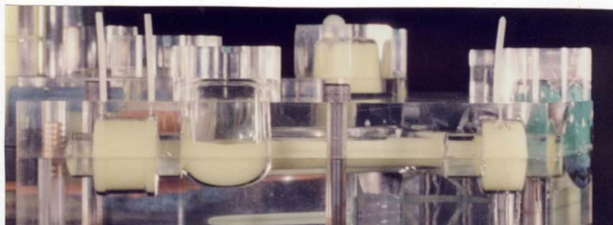
▲ Vue en coupe lors du remplissage d'un moule
