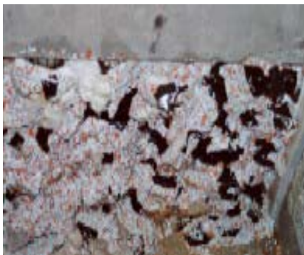
▲ Filtre en cours d'essai de colmatage
