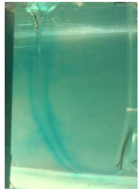
▲ Vortex dans la prise d'eau d'une pompe
