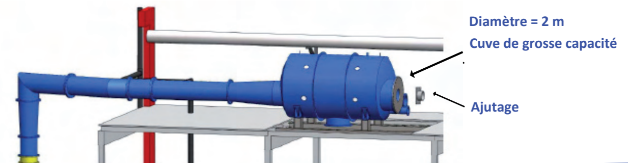
Figure 7 : Schéma de la boucle mise en œuvre par le CERG
