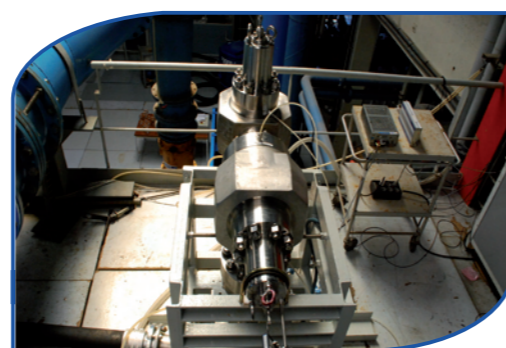
Figure 2 : Essai en eau chargée sur soupape DN200
